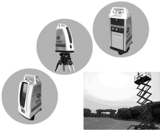
图 1 三维框架控制扫描系统硬件组成
