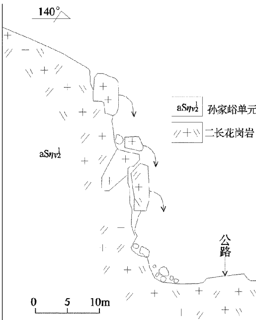
图 4 卞庄村公路北崩塌剖面示意图
