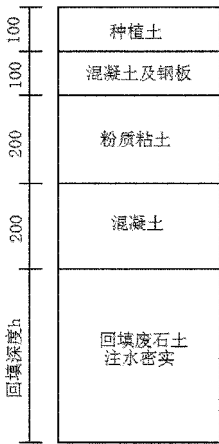
图1 竖井回填剖面示意图 (图中尺寸单位为cm)
