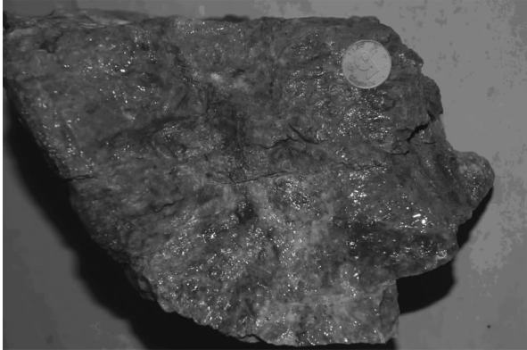
图 2 曹家洼矿区-524 水平 425 进路含金黄铁绢英岩
