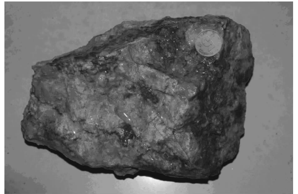
图1 曹家洼矿区-524水平425进路含金蚀变花岗岩
