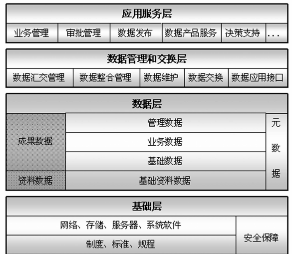
图 1 国土资源数据中心技术框架图
