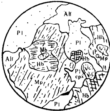
图 2 角闪石与辉石相互包裹现象 (d=2mm) 图 3 角闪石与辉石呈三边镶嵌结构 (d=2mm)
